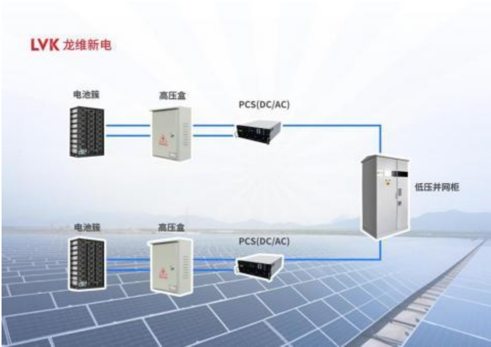
图 1-2：261kWh储能户外柜并机拓扑图（电池-PCS-并网柜）
